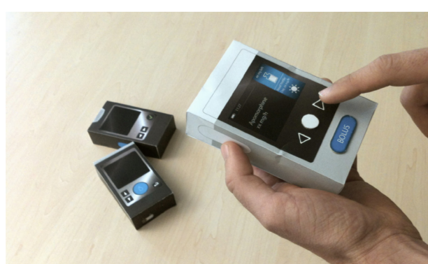
Benutzertest mit LoFi Prototyp in der Konzept Phase für eine Medikamentenpumpe
